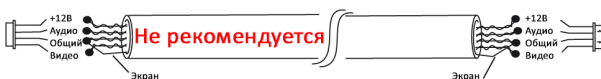
Экранированный кабель "витая пара" с подключенным экраном 4x2x0,50 (FTP-cat 5E) - дальность ~40м.
