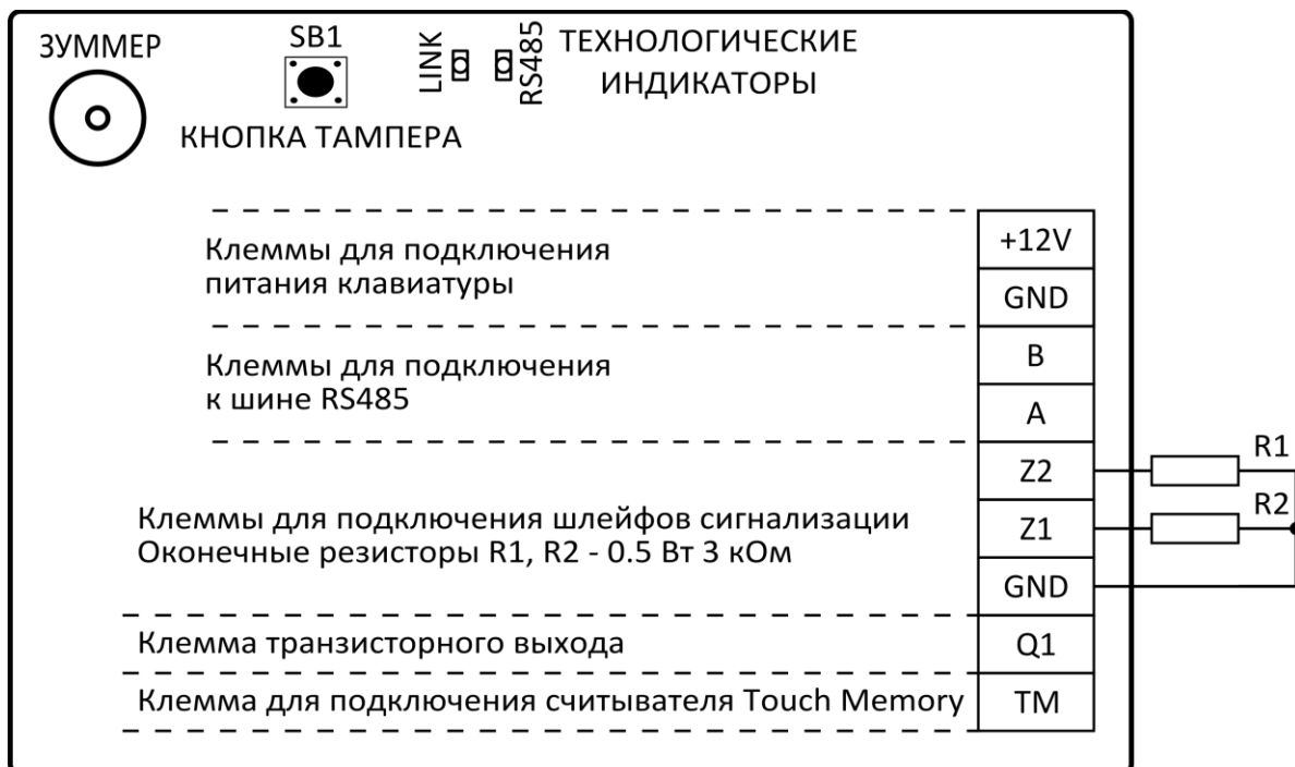
Рисунок 2 - Схема электрическая подключения
