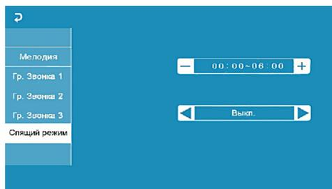
Сразу после активации спящего режима у монитора перестают работать кнопки на передней панели, на нажатия реагирует только кнопка-колесико. Если посетитель нажмёт на кнопку вызова панели, то на экране монитора на 5 секунд беззвучно появится изображение от панели и он сохранит фото. Детектор движения во время спящего режима работает штатным образом. Для возобновления работы кнопок на передней панели пользователю необходимо отключить спящий режим в экранном меню монитора, используя кнопку-колесико.
