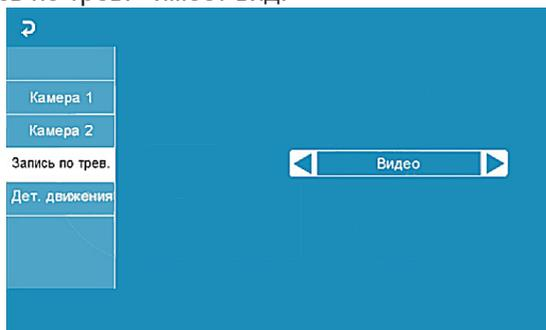
Здесь выбирается, какой тип записи будет вестись при срабатывания датчика тревоги: при установке значения «Видео» будет включаться видеозапись, а при установке значения «Фото» будет производиться захват снимка. Длительность файла видеозаписи по тревоге составляет 120 секунд.
