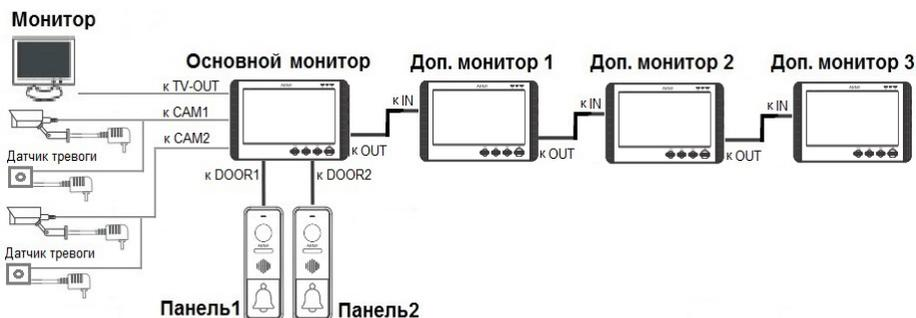
Вызывные панели подключаются только к основному монитору. Корректная работа мониторов в единой сети гарантируется только в том случае, если используются одинаковые мониторы. Подключение всех устройств следует производить только при отключенном питании монитора!
