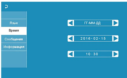
Показывать время - если активировать этот параметр, то в режиме ожидания на экране монитора будет отображаться текущее время монитора, которое будет изменять своё положение на экране раз в минуту.
