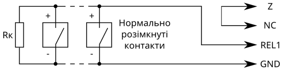
Рисунок 2.4 – Схема включення двопровідних сповіщувачів з нормально розімкнутими контактами
