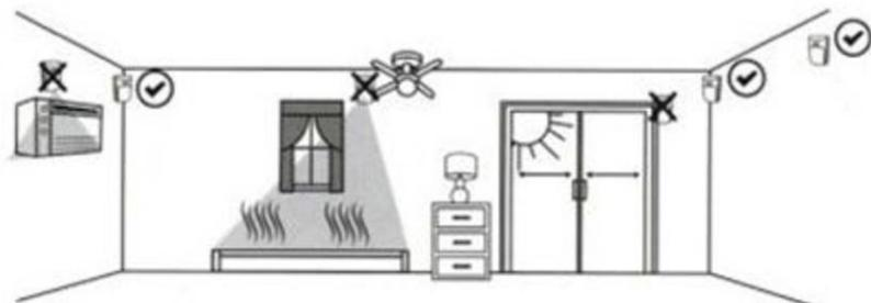
2. Рекомендованная высота установки 2-2.5 метра от пола
