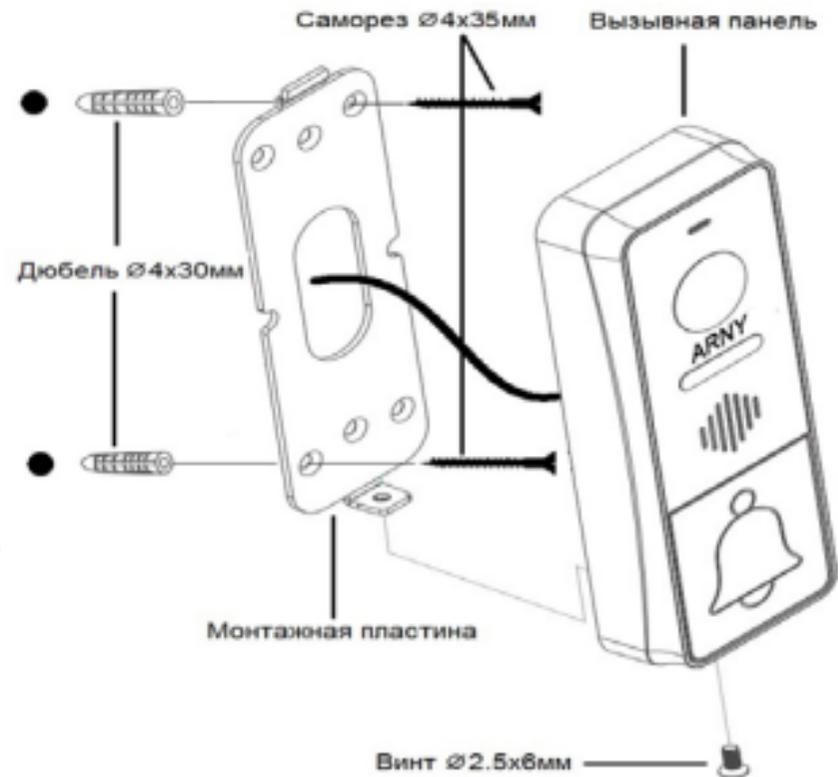
Схема установки панели с использованием монтажного уголка (в комплект не входит):
