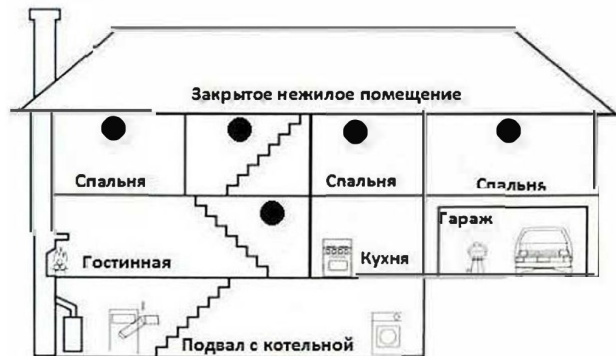
● Основные места установки сигнализаторов газа
