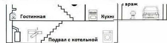
● Основные места установки сигнализаторов газа
