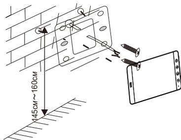
Возьмите два винта, прикрутите корпус к стене, а затем установите монитор.
